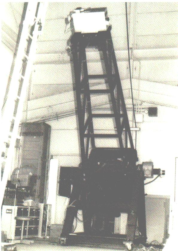
写真1 62cm薄型球面鏡能動支持試験装置。先端に鏡の形状を測るシャック・ハルトマンカメラが取り付けられている（1989年10月）。
